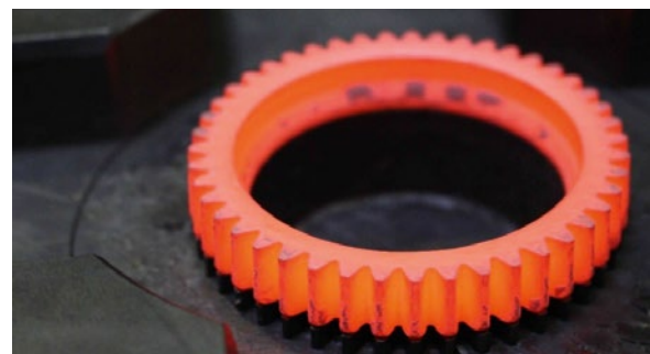
Geschmiedeter Zahnkranz aus 18CrNiMoVNb7-6
